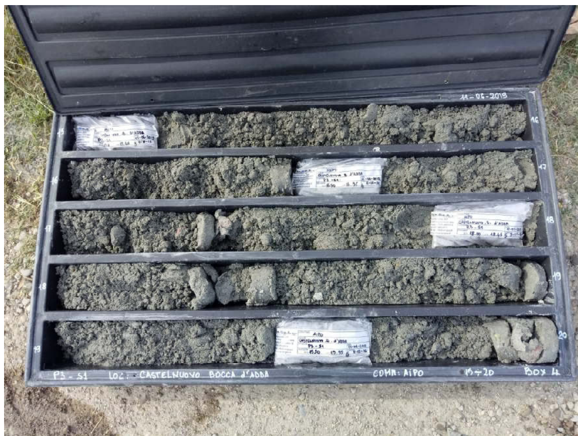
SONDAGGIO P3-S1 - Cassa n.4 da 15.00 m a 20.00 m
