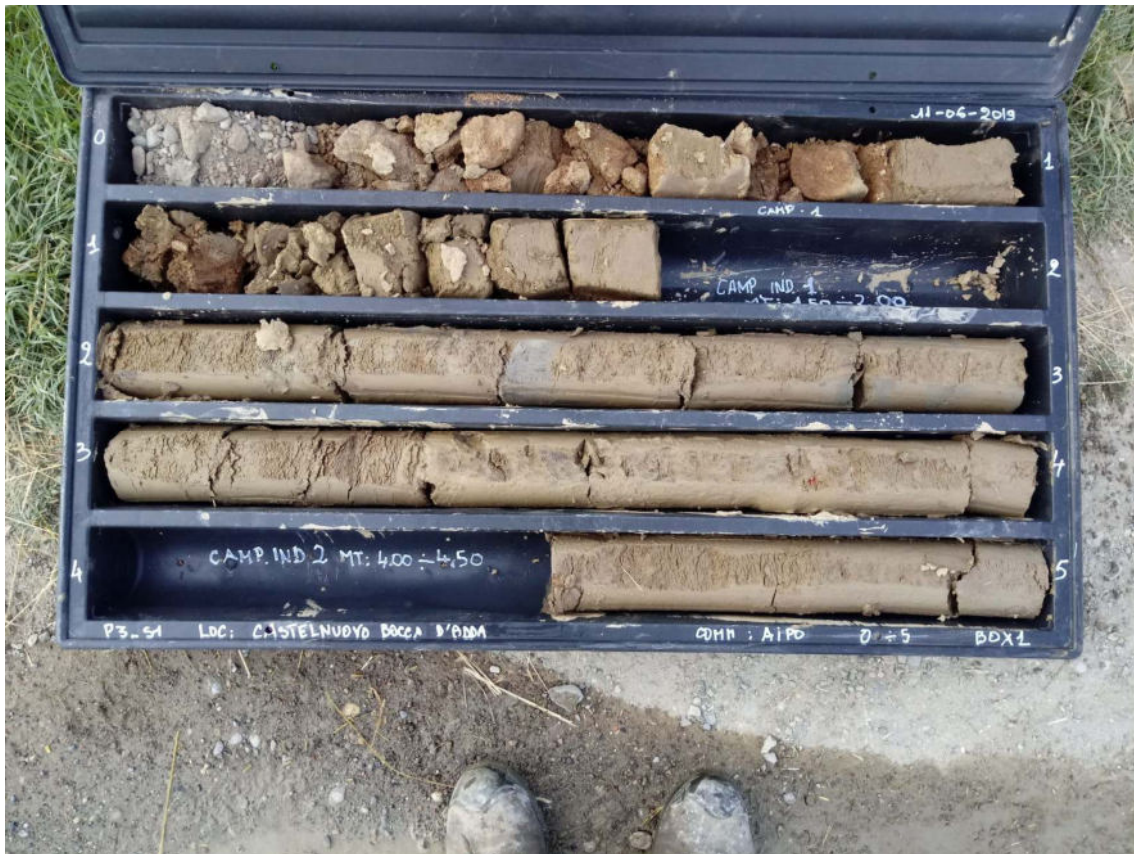
SONDAGGIO P3-S1 - Cassa n.1 da 0.00 m a 5.00 m
