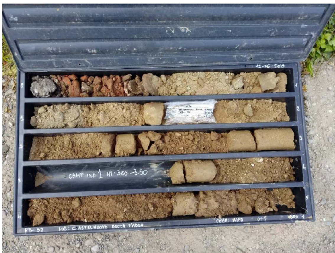
SONDAGGIO P3-S2 - Cassa n.1 da 0.00 m a 5.00 m
