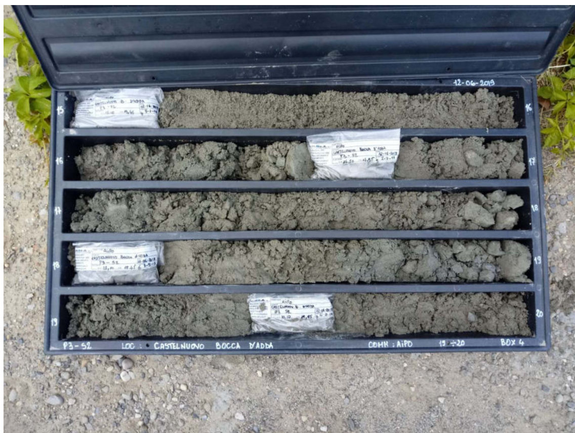
SONDAGGIO P3-S2 – Cassa n.4 da 15.00 m a 20.00 m
