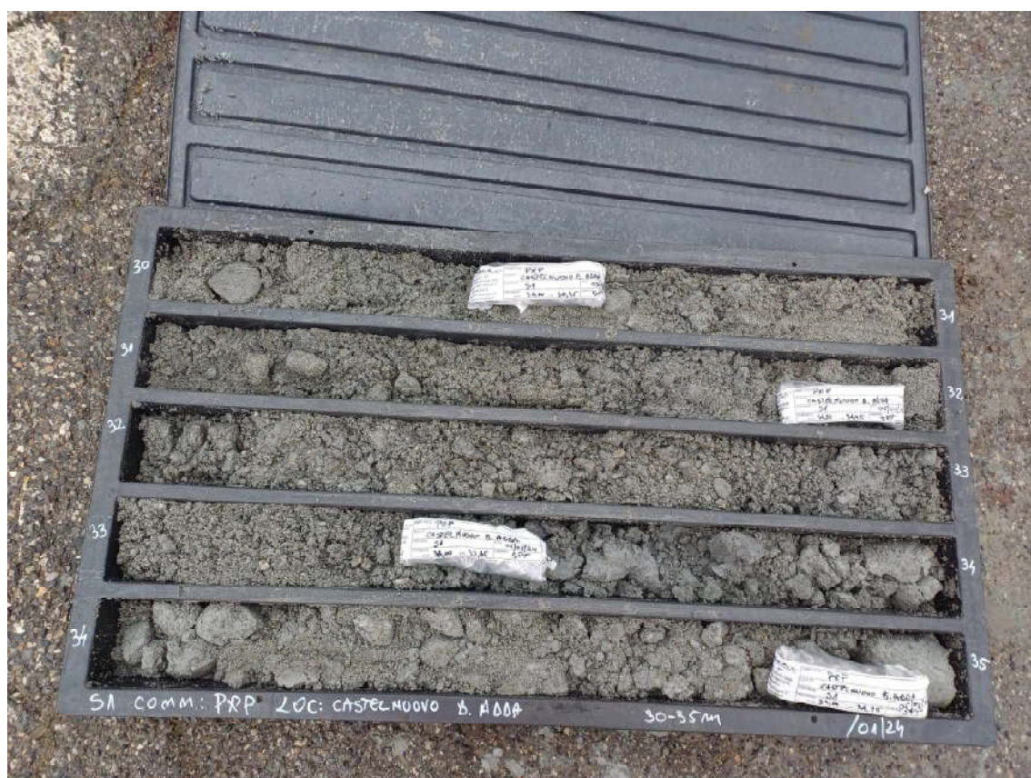
SONDAGGIO P3-S1BIS - Cassa n.3 da 30.00 m a 35.00 m
