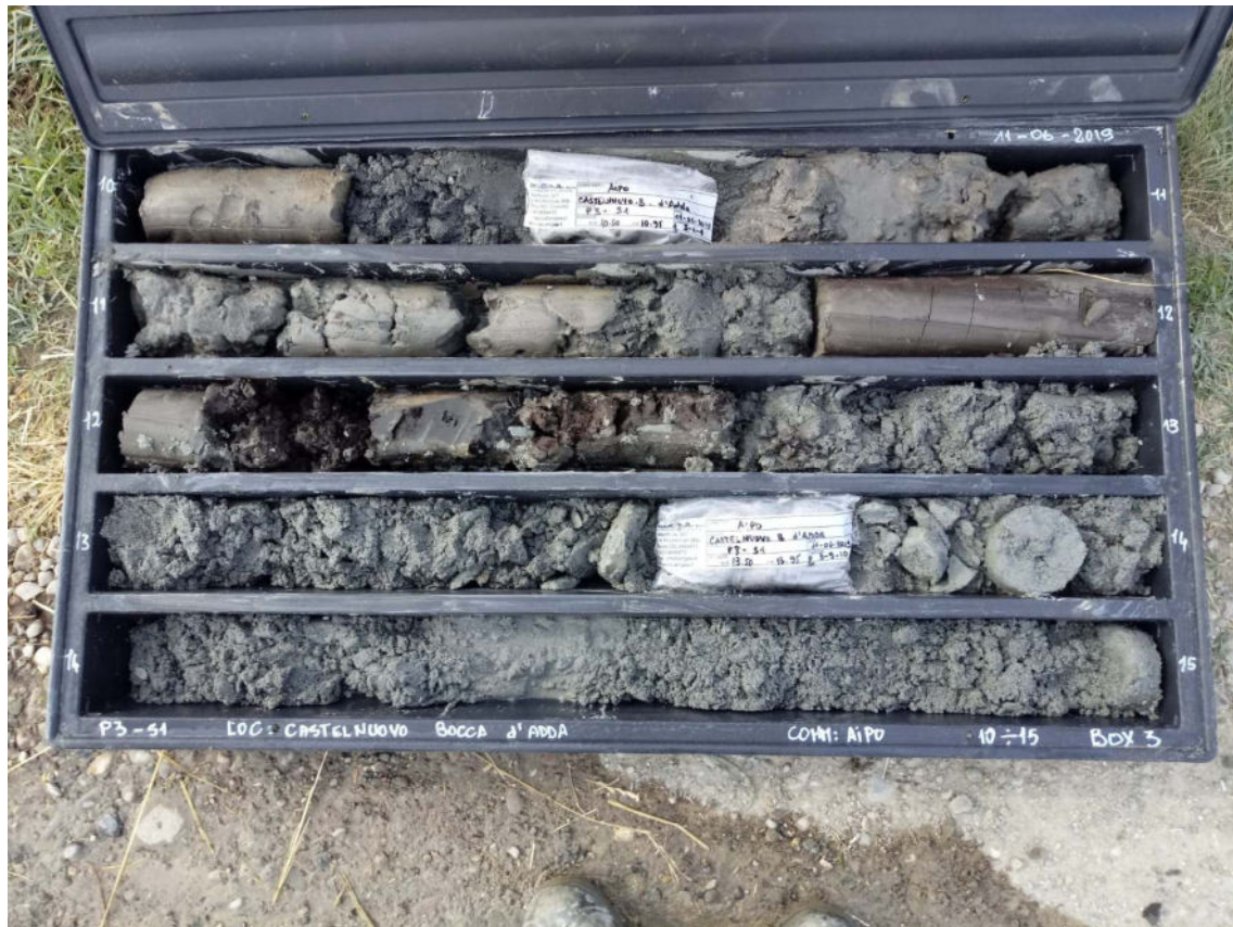
SONDAGGIO P3-S1 - Cassa n.3 da 10.00 m a 15.00 m
